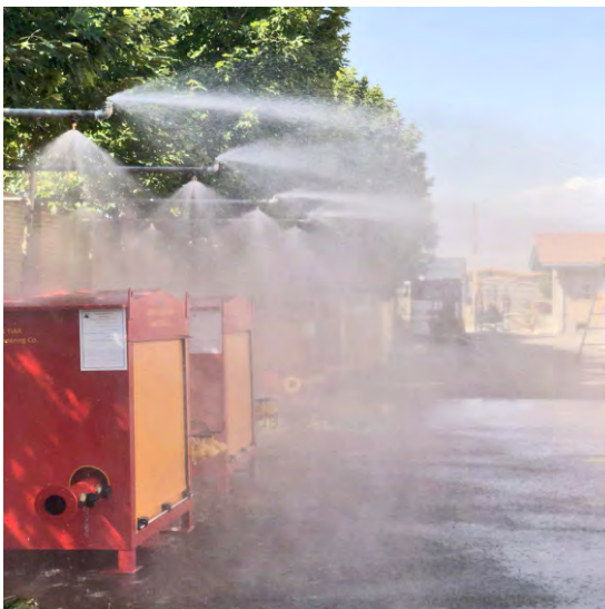
اسپرینکلر مدل سربالا Upright sprinkler head
