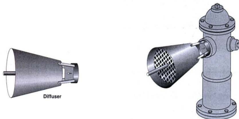
تصویر ۲- نصب دیفیوزر
