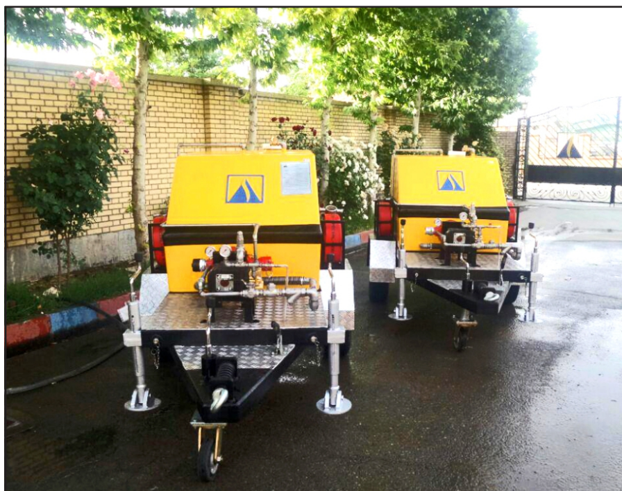
▲ فوم دوزینگ سیستم با قابلیت نصب روی تریلر
