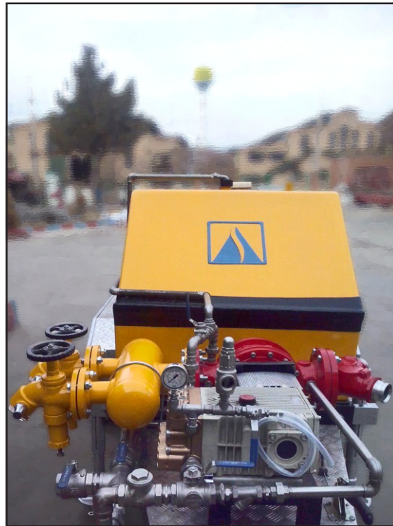
▲ فوم دوزینگ سیستم با قابلیت نصب روی تریلر
